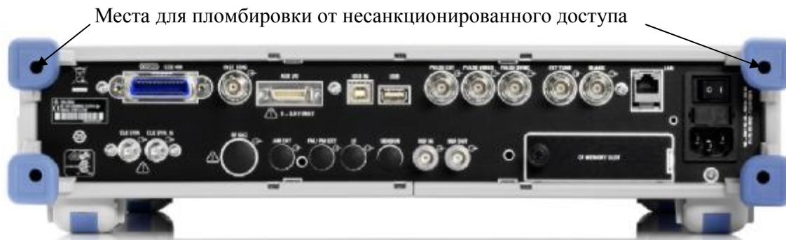
Рисунок 2 - Схема пломбировки от несанкционированного доступа
